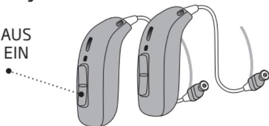
1. Schalten Sie die Hörsysteme AUS, indem Sie den unteren Teil der Taste des Hörsystems 3 Sekunden lang drücken.
