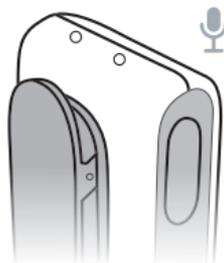
Drücken Sie die Taste 10 Sekunden lang, bis die Status-Anzeige MAGENTA aufleuchtet. EduMic befindet sich jetzt im Telefonspulen-Modus und das EduMic-Mikrofon ist deaktiviert.
