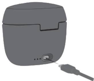
Stecken Sie das andere Ende des USB-Kabels an der Rückseite der Ladestation ein.
